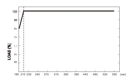
INPUT VOLTAGE (VAC) 60Hz
